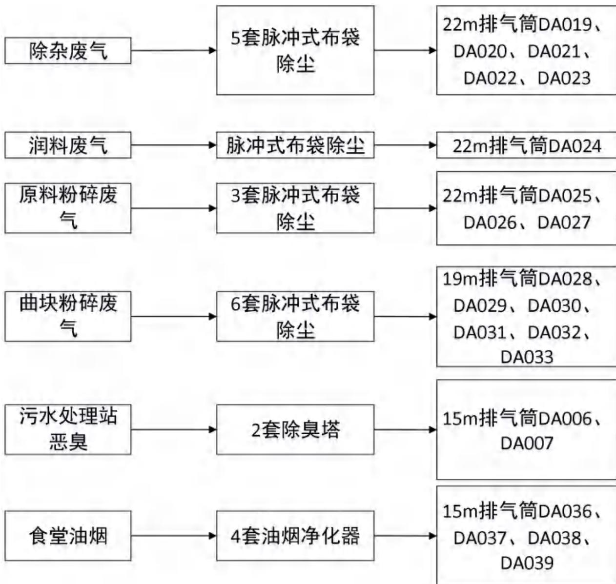
图 4-2 有组织废气产生与治理工艺流程图
